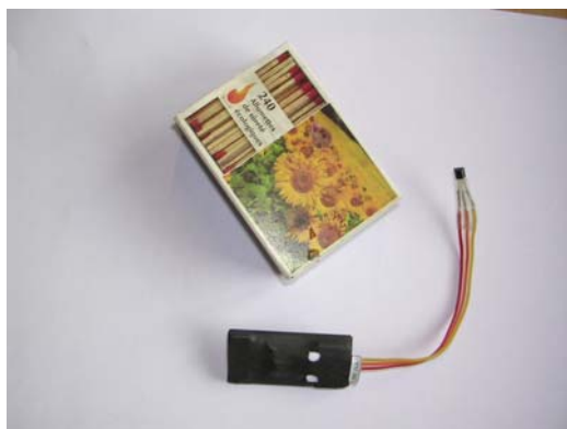
Figure 5: Thermomètre avec sa sonde et son microprocesseur – Echelle donnée par grosse boîte d'allumettes
