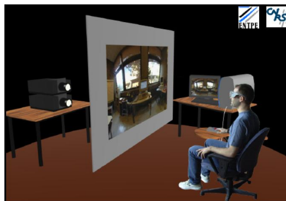
Figure 4: Simulateur de Réalité Virtuelle utilisé pour le test psychovisuel
