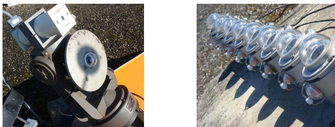
FIG. 1.27 – Gauche : solarimètre étalon Kipp & Zonnen. Droite : solarimètres sur le banc d'étalonnage.
